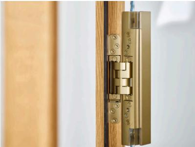
*Bildtext 3: Herzstück der „Pivota DX“-Bandserie ist das patentierte Konstruktionsprinzip aus einem symmetrischen Vier-Arm-Gelenk, das die Kräfte des Türflügels gleichmäßig in die Zarge leitet. Magnetisch gehaltene Abdeckplatten sorgen für eine schraubenfreie Optik des Bandes. Foto: Basys*
