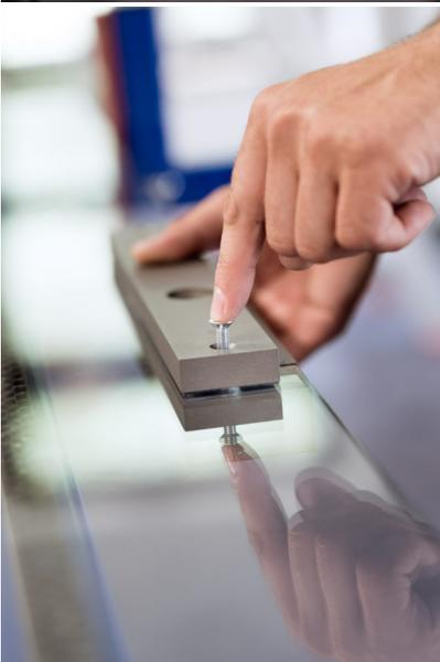
*Schritt 3/ Der Schlosskasten wird in die dafür vorbereitete Ausnehmung montiert. Auch hier schützen Kunststoffplatten und Filzstreifen das Glas. Foto: Patrick Hamacher, PH.OTOGRAPHIE, Würzburg*
