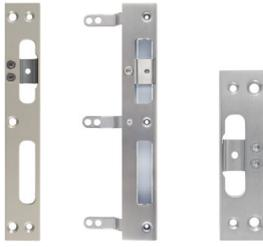
*Bildtext 2: Seine Schließblechsysteme „Stabilo“ präsentiert Basys zur BAU 2019 erstmals durchgängig mit der Justierfunktion. Dazu findet sich in der Fallenöffnung ein u-förmiges Edelstahlprofil, das sich nach Lösen der Klemmschraube mit einem kleinen Schraubendreher in horizontaler Richtung bewegen lässt. Foto: BaSys*
