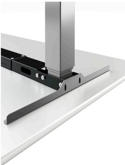
*Bildtext 1: Eine Person kann den elektrisch höhenverstellbaren Tisch allein aufbauen. Das „OH“-Montageprinzip steht für „overhead“. Es bedeutet, dass die Tischplatte zunächst auf dem Kopf liegt und der Monteur den steckbaren Plattenrahmen bequem daran befestigen kann. Der Rahmen nimmt dann die Säulen formschlüssig auf und hält sie in Position. Damit sind beide Hände frei, um nun erst die Säulen seitlich und anschließend die Fußausleger zu verschrauben. Foto: Kesseböhmer Ergonomietechnik*
