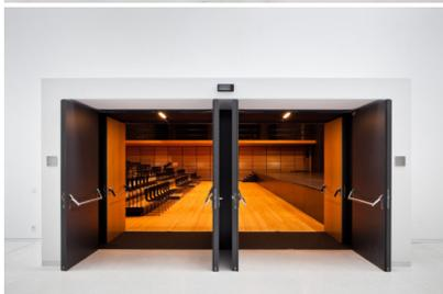
*Bildtext 3: Die bis 200 Kilogramm schweren Objektüren von Herholz erfüllen im Multimediakomplex Karlsruhe nicht nur gleichzeitig alle Anforderungen an moderne Flucht-, Brand- und Schallschutztüren, sondern zeigen sich mit zwei Oberflächenoptionen auch ästhetisch flexibel. Das verdeckt liegende Band „Pivota DX 180 3D“ von BaSys unterstützt die Türen in ihrem Design und der multifunktionalen Anwendung. Foto: Daniel Vieser Architekturfotografie, Karlsruhe, [www.dv-a.de](http://www.dv-a.de)*
