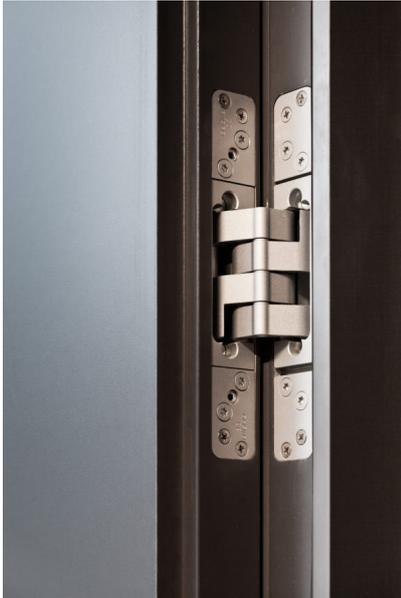
*Bildtext 4: Das Herzstück des verdeckt liegenden Türbandes „Pivota DX 180 3D“ von BaSys: vier Kolben lagern das Gelenk und lenken die auftretende Kräfte in jede Richtung. Das Prinzip sorgt selbst bei extremen Gewichten für eine hohe Stabilität. Foto: Daniel Vieser Architekturfotografie, Karlsruhe, [www.dv-a.de](http://www.dv-a.de)*
