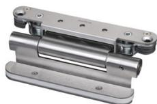
*Bildtext 4: Eine Stiftsicherung, die allen „Objecta“-Türbändern eigen ist, erfüllt den Zusatznutzen der Einbruchhemmung. So auch beim „Objecta 2029/120/56 D15 Gracila“ mit „STV 120/56 3-D“ für stumpf einschlagende Türen. Der Rollendurchmesser von nur 15 mm lässt das Band besonders grazil erscheinen. Foto: Basys*
