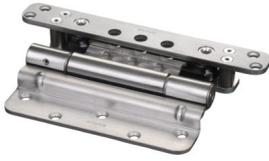
*Bildtext 5: Beim „Objecta 2540/160/48-4 mit STV 116/48 3-D“ gut zu erkennen: Das Band kommt ohne die üblichen Kopfschrauben am Rollenschaft aus – das sorgt für mehr Sicherheit und eine schönere Optik. Foto: Basys*
