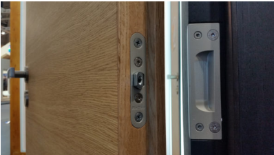
Bildtext 3: Mit einer externen Bandseitensicherung lassen sich Eingangstüren für die Widerstandsklasse RC3 sichern. Die Lösung von Basys wird flügelseitig mit einem entsprechenden Gegenstück in der Zarge montiert und bleibt für die sichere Verbindung justierbar. Foto: Basys
