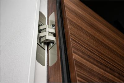
*Bildtext 2: Die verdeckt liegenden Bänder von Basys weisen paarweise eine hohe Tragfähigkeit und Belastbarkeit auf. Ein stabiles symmetrisches Vier-Arm-Gelenk leitet die Kräfte des Türflügels gleichmäßig in die Zarge. Die patentierte Kolbenführung sorgt für Leichtgängigkeit; 3D-Verstellung und wartungsfreie Dauerfunktion erleichtern die Montage. Foto: Erol Gurian*
