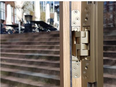
*Bildtext 5: Herzstück der „PIVOTA“-Bandserie von Basys ist das patentierte Konstruktionsprinzip. Ein symmetrisches Vier-Arm-Gelenk leitet die Kräfte des Türflügels gleichmäßig in die Zarge. Das Prinzip verleiht den Türen eine leichtgängige Mechanik. Es nimmt die Flügelgewichte zuverlässig auf und sorgt in Verbindung mit dem verwendeten massiven Material für eine hohe Stabilität. Foto: Basys*
