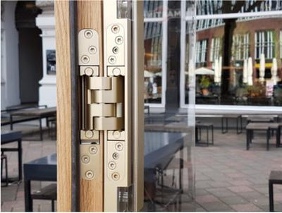
*Bildtext 3: Glastüren, die mit dem „PIVOTA DX Glass“ ausgestattet sind, lassen sich bis 180 Grad öffnen, sind wartungsfrei gelagert und dreidimensional justierbar. Foto: Basys*
