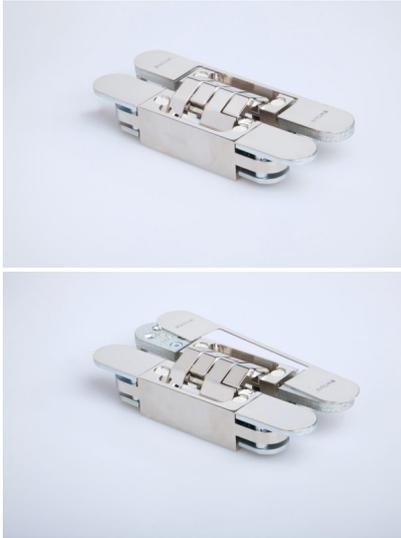
*Bildtext: Magnetisch gehaltene Metallplatten decken die Schraubenbereiche der verdeckt liegenden Basys-Bänder so ab, dass eine komplett schraubenfreie Optik entsteht. Das „Design+“ führt die schlichte Eleganz am Zargenteil des Bandes fort, wo eine durchgehende Abdeckplatte die Ausfräsung in der Türzarge versteckt, so dass auch der ausgefräste Zargenwerkstoff unsichtbar bleibt. Foto: Basys*
