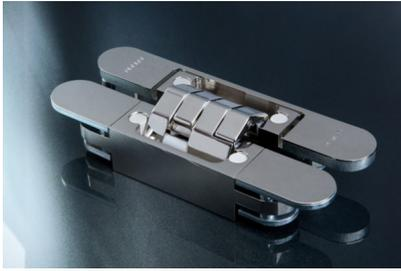
*Bildtext: Magnetisch gehaltene Metallplatten decken die Schraubenbereiche der verdeckt liegenden Basys-Bänder so ab, dass eine komplett schraubenfreie Optik entsteht. Das „Design+“ führt die schlichte Eleganz am Zargenteil des Bandes fort, wo eine durchgehende Abdeckplatte die Ausfräsung in der Türzarge versteckt, so dass auch der ausgefräste Zargenwerkstoff unsichtbar bleibt. Foto: Basys*
