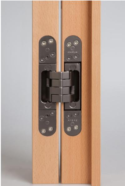
*Bildtext: Magnetisch gehaltene Metallplatten decken die Schraubenbereiche der verdeckt liegenden Basys-Bänder so ab, dass eine komplett schraubenfreie Optik entsteht. Das „Design+“ führt die schlichte Eleganz am Zargenteil des Bandes fort, wo eine durchgehende Abdeckplatte die Ausfräsung in der Türzarge versteckt, so dass auch der ausgefräste Zargenwerkstoff unsichtbar bleibt. Foto: Basys*
