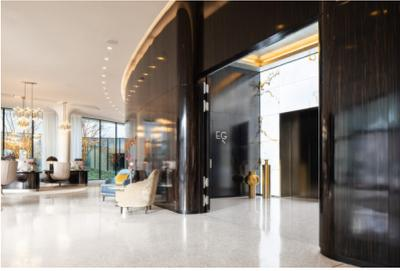
*Bildtext 1: Eine Sonderlösung des Rollenbandsystems „Objecta“ im Einsatz in der Fahrstuhllobby des Grandhotels „The Fontenay“ in Hamburg. Die riesigen Türblätter mit Aufdopplung stehen 180 Grad geöffnet und schließen im Brandfall automatisch. Foto: Daniel Vieser Architekturfotografie, Karlsruhe, [www.dv-a.de](http://www.dv-a.de)*
