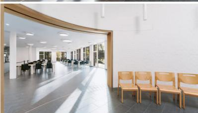
*Bildtext 2: Die maßgeschneiderte Schiebetüranlage folgt dem bogenförmigen Verlauf der Wand und verschwindet geöffnet komplett im Mauerwerk. Foto: Hawa Sliding Solutions AG*
