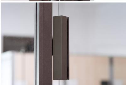
*Bildtext 3: Verdeckt liegendes Glastürband „Pivota DX Glass“: Das Rahmenteil verschwindet in der Zarge, das Flügelteil in einem mit der Glastür verschraubten und geklemmten Kasten. Foto: Patrick Hamacher, PH.OTOGRAPHIE, Würzburg*
