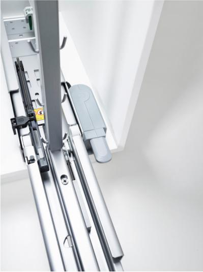
*Bildtext 3: Ein leichter Druck auf die Front eines „CONVOY“, DISPENSA“ oder „TANDEM“ genügt – mit dem neuen „eTouch+“ öffnet sich der Hochschrank einen Spalt breit (44 mm) und kann durch Dahinterfassen mit einer Hand aufgezogen werden. Der Clou: Wird die Front nicht weiter geöffnet, schließt der Schrank nach etwa drei Sekunden selbsttätig. Foto: Kesseböhmer*
