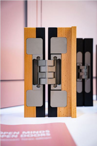
Bildtext 7: Lösung für beidseitigen Aufdopplungen bis 24 mm: „Pivota DX 180 3-D Design BFP“. Die breite Frontplatte (BFP) erlaubt mehr Verschraubungspunkte im Kernholz. Foto: Basys
