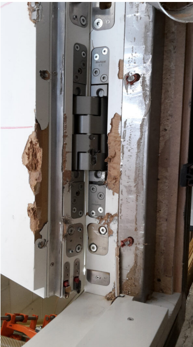
Bildtext 5: Das „Pivota DXS 300 3-D Steel Safe“ bietet hohe Sicherheit beim Rauch-, Brand- und Einbruchschutz. Es weist eine Tragfähigkeit von 350 Kilogramm pro Paar auf und besteht ausschließlich aus Stahl. Die integrierte Bandseitensicherung verhindert, dass sich der Türflügel horizontal oder vertikal verschieben lässt. Das Bild zeigt das Band nach bestandener Einbruchprüfung. Foto: Huber Form Schreinerei GmbH, Triftern-Neukirchen
