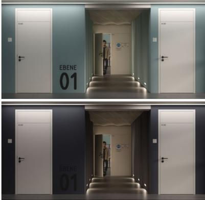
*Bildtext 2: Oberblenden erweisen sich insbesondere in Büro- und Konferenzbereichen als nützlich, wo sie herausgenommen den Transport großer Möbel oder Geräte ermöglichen. Die Beschlagteile, mit denen sich die Blende millimetergenau an Türblatt und Zarge ausrichten lässt, spielen eine wesentliche Rolle. Foto: Basys*
