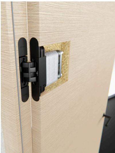
*Bildtext 1: Mit dem verdeckt liegenden Band „Pivota DXS Close“ schließen Türen sanft und selbsttätig. Version 2.0 ist mit einem Stahlgelenk und einer damit verbundenen Schließmechanik ausgestattet, die wie das Band in der Türfräsung verschwindet. Im Gegensatz zur Ursprungsversion präsentiert sich das „Pivota DXS Close 2.0“ etwas kompakter, woraus lediglich eine größere Ausfräsung im Türblatt resultiert. Foto: Basys*
