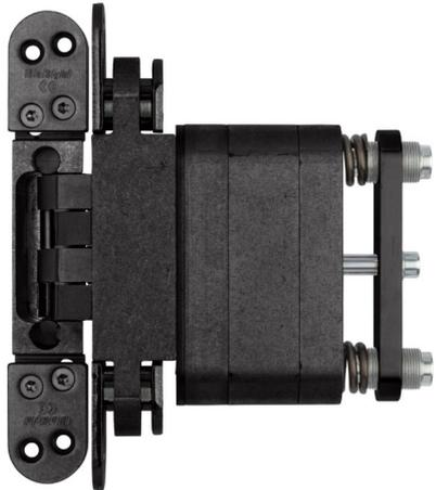
*Bildtext 2: Das „Pivota DXS Close 2.0“ funktioniert mechanisch: Über zwei Spindeln lassen sich die Federn vorspannen und die Zugkraft skalieren. Die integrierte Dämpfung ist bei Version 2.0 zudem viskos gelagert, so dass sich die Dämpfungsstärke flexibel der Schließgeschwindigkeit der Tür anpasst. Foto: Basys*
