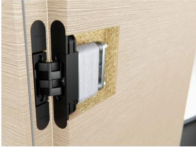
*Bildtext 1: Mit dem verdeckt liegenden Band „Pivota DXS Close“ schließen Türen sanft und selbsttätig. Version 2.0 ist mit einem Stahlgelenk und einer damit verbundenen Schließmechanik ausgestattet, die wie das Band in der Türfräsung verschwindet. Im Gegensatz zur Ursprungsversion präsentiert sich das „Pivota DXS Close 2.0“ etwas kompakter, woraus lediglich eine größere Ausfräsung im Türblatt resultiert. Foto: Basys*
