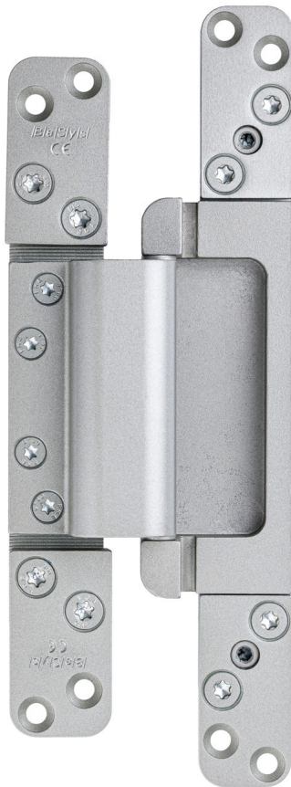
Bildtext 1: Beim alten Modell des „Masterband FX2 120 3-D FD“ lag die seitliche Falzlufjustierung noch im Flügelteil des für Haustüren entwickelten verdeckt liegenden Bandes. Bei der Justierung kam es allerdings mitunter zur Verschiebung der flügelseitigen Aufdeckdichtung – mit negativen Auswirkungen auf das für Haustüren wesentliche Kriterium der Dichtigkeit. Foto: BaSys
