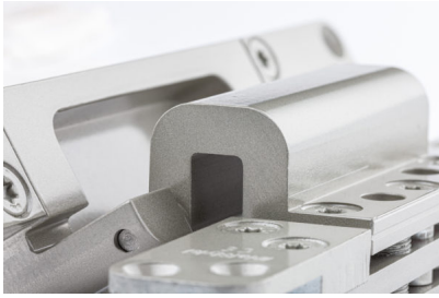
Bildtext 3: Das „Masterband FX2 120 3-D FD“ erhielt bereits eine der begehrten „Winner“-Auszeichnungen beim German Design Award. Es weist eine Tragfähigkeit von 120 Kilogramm pro Paar auf, ist wartungsfrei gelagert und dreidimensional einstellbar – neuerdings ohne negative Auswirkungen auf die Dichtigkeit der Haustür. Foto: BaSys
