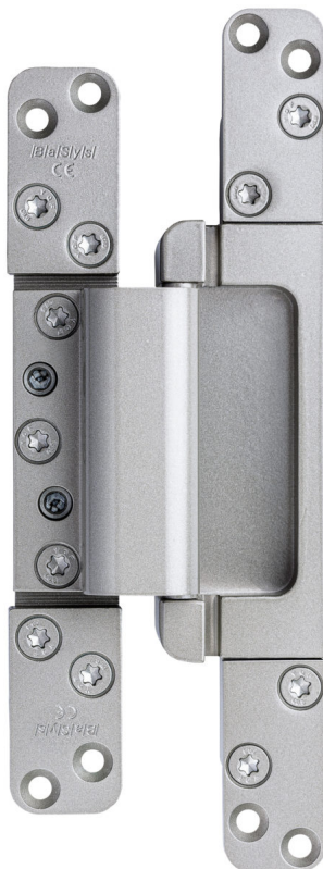
Bildtext 2: Beim neuen Modell des „Masterband FX2 120 3-D FD“ liegen nun alle drei Justierarten – die seitliche Falzlufjustierung, die Höhenverstellung und der Anpressdruck der Dichtung – im Zargenteil des Bandes. Das Flügelteil und die vom Band umschlossene Aufdeckdichtung werden bei der Justage nicht bewegt. Foto: BaSys
