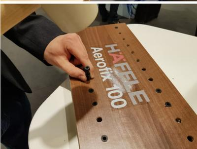
**Bildtext 9:** Decklagen zu verbinden, darum ging es an der Werkbank von Häfele, Nagold. Der Fokus richtete sich dabei auf den Dübel „Aerofix 100“, der mit Kleberkartusche und Spreizhaken bei Decklagen bis 4 mm und Plattenstärken ab 30 mm eine Auszugkraft von 750 bis 900 Newton erreicht. Foto: igeL
