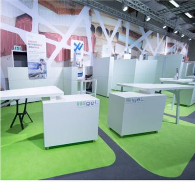
*Bildtext 38: Langlebig, modular und wiederverwendbar sind die Zwischenwände, die Formatdisplay, Leutenbach, für die Messestände der igeL-Mitglieder auf der ZOW herstellte. Das Wandsystem in Rahmenbauweise mit Wabenkern ist hochwertig verarbeitet und lässt sich werkzeuglos montieren. Foto: Koelnmesse*
