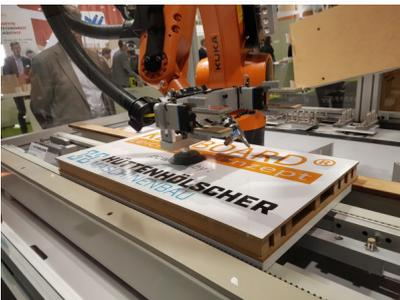
**Bildtext 18:** Mit von der Partie auf dem igeL-Gemeinschaftsstand zur ZOW war die Firma Hüttenhölischer Maschinenbau aus Verl. Sie zeigte eine Roboterzelle zur automatisierten Fertigung von „Kettboard“-Leichtbauplatten. Foto: igeL
