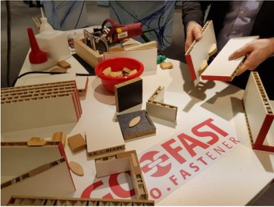
**Bildtext 14:** An der Werkbank der Hochschule Ostwestfalen-Lippe, Lemgo, stellten Studenten „Wood Insert“ und Wood Spring“, letzterer eine Art „Lamello“ für den Leichtbau, vor. Die beiden im täglichen Handling des Schreiners einfach einzusetzenden Holzbauteile ergeben dauerhaft stabile und vielfältige Verbindungslösungen für Leichtbauplatten. Foto: igeL
