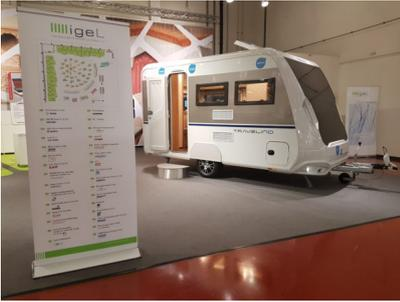
**Bildtext 24:** „Ultralight“ kommt der „Travelino“ vom Caravan- und Wohnwagenhersteller Knaus Tabbert daher. Sandwich-Aufbau, Multi-Core-Materialien, Coldmelt- und Formpress-Technologie tragen dazu bei, einen vollwertigen Vier-Personen-Wohnwagen mit 750 Kilogramm zulässigem Gesamtgewicht zu realisieren. Mit Würth und Lightweight Solutions beteiligten sich zwei weitere igeL-Mitglieder an der Entwicklung dieser neuen Wohnwagengeneration. Foto: igeL
