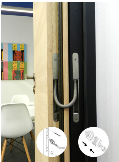
Bildtext: Der Kabelübergang „Pivota Connect“ verschwindet in einer falzseitigen Fräsung und sichert die Energieversorgung zwischen Zarge und Türflügel – Voraussetzung, um die Tür mit zusätzlichen Sicherheits- und Komfortmerkmalen auszustatten. Jetzt gibt es das System auch mit Steckverbindern. Foto: Basys
