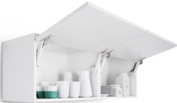
*Bildtext 2: Der neue Klappenbeschlag „FREEspace“ präsentiert sich mit minimaler Einbautiefe, schlanker Frontanbindung und in den Hebelarm integrierter Feder deutlich abgespeckt. Foto: Kesseböhmer*
