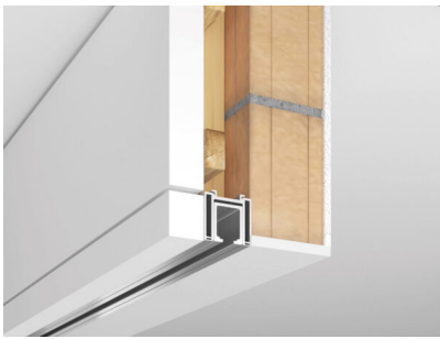
Bildtext 1: Das Schiene-in-Schiene-System bei der Pocket-Lösung des „Hawa Junior 100“ bietet den Vorteil, dass es sich sauber montieren lässt, auch dann, wenn die Wandtasche bereits malerfertig ist. Foto: Hawa Sliding Solutions
