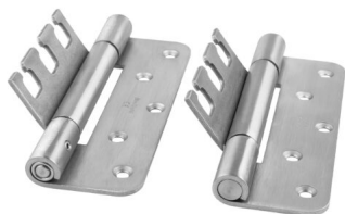
Bildtext 1: BaSys hat das Objekttürbandsystem mit 18 mm Rollendurchmesser auf ein neues Konstruktionsprinzip umgestellt. Links das Vorgängermodell mit durchgehender Achse und Stiftsicherung, rechts das neue Modell. Foto: BaSys
