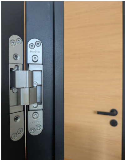
Bildtext: Das „Pivota DX 35 3-D LT“, dreidimensional justierbare Version eines kostengünstigen Einsteigermodells im Bereich verdeckt liegender Bänder für stumpf einschlagende Türen, ist nun pro Paar für ein Türgewicht von 60 kg freigegeben. Foto: Basys
