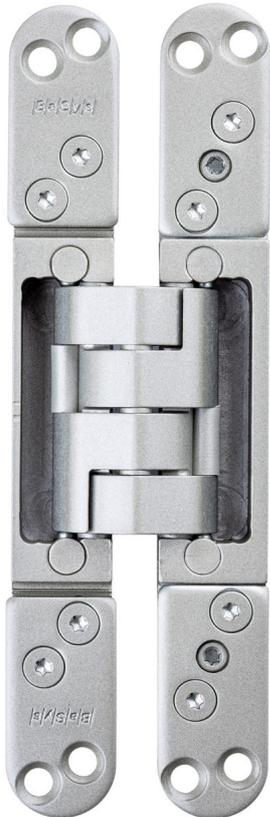
*Bildtext 2: Der größere Abstand der beiden Bandkörper zueinander beim neuen „Pivota DX 38 N 3-D“ sorgt dafür, dass das Band auf Flügel- und Zargenseite tiefer ins Material eingefräst werden kann. Das stabilisiert die Gesamtkonstruktion. Foto: BaSys*
