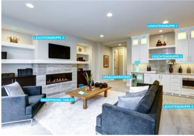
*Bildtext 2: Die „L&S Emotion“-Technologie erlaubt es, mehrere Leuchtengruppen über eine Smart Home-Anbindung mit dem Smartphone/Tablet oder per Sprachassistent zu steuern und so die Beleuchtung jederzeit an den individuellen Bedarf anzupassen. Foto: L&S*
