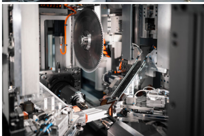
3b: Das Besondere: In einem einzigen platzsparenden Modul befinden sich zwei gleichzeitig arbeitende, gegenüberliegende 5-Achs-Fräsköpfe mit je einem Werkzeugwechsler und eine Säge von oben. Die Profile werden für die zueinander in Bezug stehenden Bearbeitungen nur einmal aufgespannt. Jede Bearbeitungsspindel ist mit einem automatischen 20fach-Werkzeugwechsler ausgestattet.
