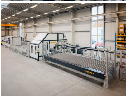
Bildtext 3: Ein für Bosch Rexroth kundenindividuell konfiguriertes Durchlaufzentrum für die Bearbeitung von Aluminium-Konstruktionsprofilen. Fotos: Schirmer Maschinen
