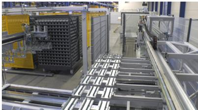
*Bildtext 4: Das Stahlbearbeitungszentrum mit automatischer Abstapelung und Einsortierung der Stahlprofile in die Fachwagen. Foto: Schirmer Maschinen*
