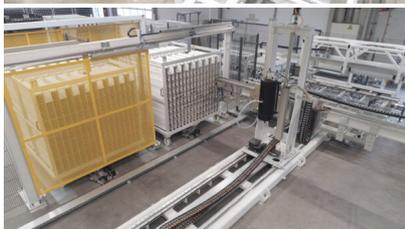
*Bildtext 6: PVC-Bearbeitung mit Abstapelung: Alle Flügel- und Rahmenteile finden ihren Platz in Fachwagen für die Weiterverarbeitung. Foto: Schirmer Maschinen*
