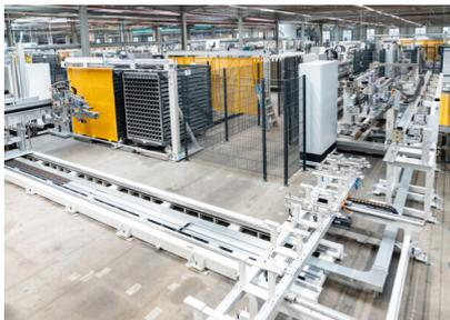
*Bildtext 5: Die Stahlprofile stehen bereit. Positioniert und fein ausgerichtet in den 160 Kassetten der Fachwagen. Gezielt greift sich hier der Roboterarm des Schirmer Bearbeitungszentrums eines heraus, dreht es bei Bedarf und vermisst es. „Einzig am Markt“: Der automatische Stahleinschub. Hier findet jedes Stahlprofil exakt sein passendes PVC-Pendant. Foto: Mario Dirks, Oldenburg, für Schirmer Maschinen*
