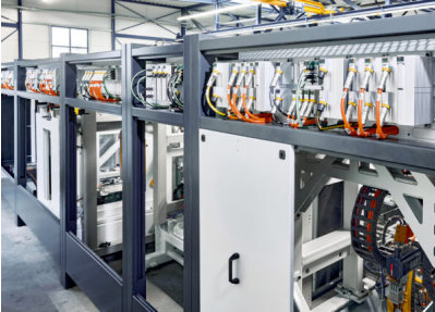
Bildtext 4: Schirmer stellt für die Automatisierung seiner Anlagen komplett auf die steckbare „MX“-Systemlösung von Beckhoff Automation um. Sie ersetzt den Schaltschrank vollständig. Foto: Beckhoff Automation
