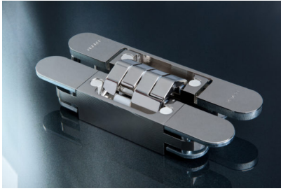
Bildtext 5: Das „Pivota DX 61 3-D“ in der Oberfläche poliert vernickelt: aktuelles Beispiel für ein verdeckt liegendes, dreidimensional justierbares Band für stumpf einschlagende Türen. In der „Design+“-Version decken magnetisch gehaltene Platten die Schraubenbereiche und die Ausfräsung in der Türzarge ab. Foto: BaSys
