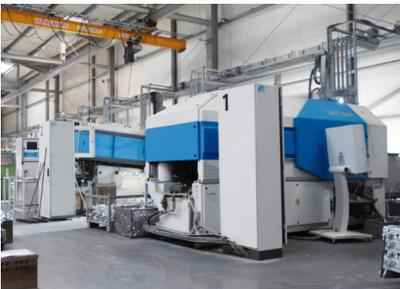
*Bildtext 2: Schwinn-Standort in Krakau/Polen: Zinkdruckgussmaschinen. Foto: Schwinn*
