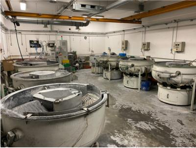
*Bildtext 3: Schwinn-Standort in Krakau/Polen: Gleitschleifen/Trowalisieren. Foto: Schwinn*
