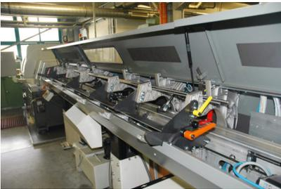
*Bildtext 7: Schwinn-Standort in Krakau/Polen: Langdrehmaschine für Stangengriffe. Foto: Schwinn*
