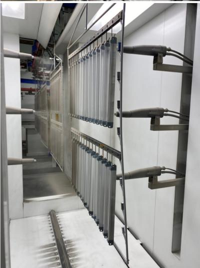
*Bildtext 5a und b: Schwinn-Standort in Krakau/Polen: Pulverbeschichtungsanlage. Foto: Schwinn*
