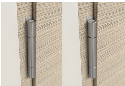
Bildtext: Das neue „Objecta 2039/160/56-4“ für gefälzte Türen (links) kommt mit einem Rollendurchmesser von nur 20 mm schlanker daher, kann aber wie das „2239er“ (rechts) auch 300 Kilogramm schwere Türen tragen. Daneben gibt es eine Version mit Flügeldichtung und eine Version für stumpf einschlagende Türen. Foto: BaSys
