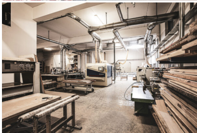
Bildtext 2: Blick in die Masei-Holzmanufaktur: Zur Werkstattausstattung gehören eine CNC- und eine Breitbandschleifmaschine, eine Furnierpresse sowie die Lackiererei. Foto: Masei
