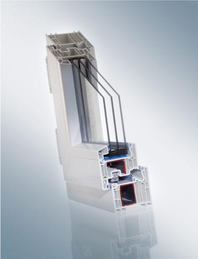
*Bildtext 1: Baltic-Fenster mit dem Veka-Profilssystem „Softline 82“ mit einer Außenwandstärke von 3 mm vereinen Energiespareigenschaften, Langlebigkeit und Sicherheit. Es erreicht eine Belastungsklassifizierung von B3-9A-4 und liegt damit über den Einsatzempfehlungen des ift Rosenheim. Foto: Veka*
