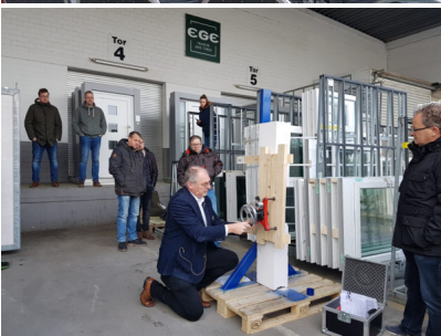
Bildtext 8: Michael Kracht vom EGE-Technikzentrum erläutert, wie die Standsicherheit von Bauteilen, die gegen Absturz sichern, beurteilt wird. Befestigungsmittel, Dübel sowie Befestigungsabstand ändern sich in Abhängigkeit von Holmlast, Fenstergröße, Einbausituation und Mauerwerksfestigkeiten. Foto: EGE
