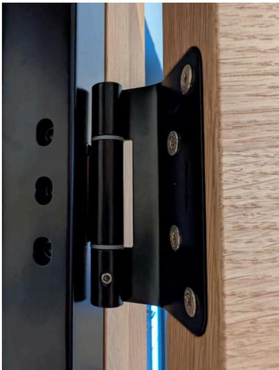
*Bildtext: „Combica STV Inclino 3-D“. Das Band wird für die Einstellung der seitlichen Falzluft innerhalb der Bandaufnahme gekippt. Das ermöglicht insbesondere im Bereich der leichteren Bandsysteme für Wohnungstüren die präzise und simple 3-D-Einstellung – sowohl in Holz- als auch wie hier in Stahlzargen. BaSys konzipierte „STV Inclino 3-D“ für alle Bänder mit einem handelsüblichen, aus dem Stahlzargenbereich bekannten Mittelteil. Foto: Basys*
