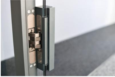
*Bildtext 2: Mit dem „Pivota DX Glass“ adaptiert Basys die bewährte Technik seiner verdeckt liegenden Bänder auf die Anwendung an Glasdreh Türen – mit entsprechenden Vorteilen hinsichtlich der Skalierbarkeit der Tragfähigkeit sowie der bestehenden CE-Zertifizierung. Magnetisch gehaltene Abdeckplatten sorgen für eine schraubenfreie Optik des Bandes. Foto: The Design Patrick Banasik, Gemünden*
