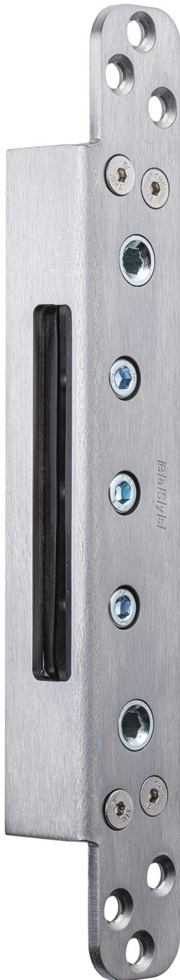
*Bildtext: Den Schlitz der Bandaufnahme „STV 135/56 3-D“ für Türgewichte bis 350 Kilogramm pro Paar stattete Basys nun mit einer Dichtlippe aus, damit gerade bei Türen in der Gebäudehülle kein Regenwasser eindringen kann.
