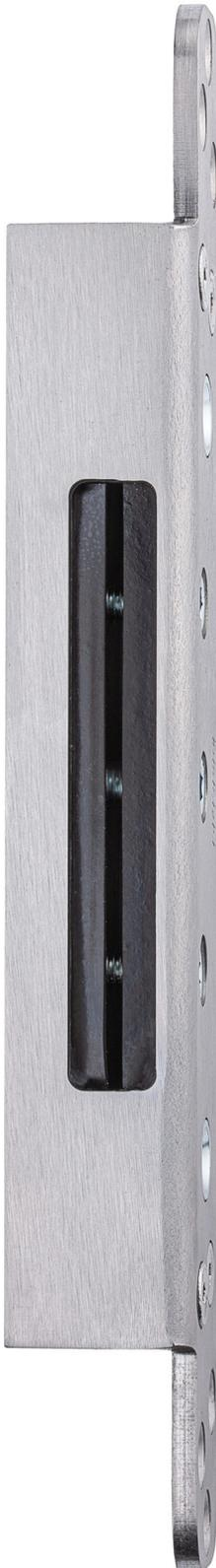
*Bildtext: Den Schlitz der Bandaufnahme „STV 135/56 3-D“ für Türgewichte bis 350 Kilogramm pro Paar stattete Basys nun mit einer Dichtlippe aus, damit gerade bei Türen in der Gebäudehülle kein Regenwasser eindringen kann.
