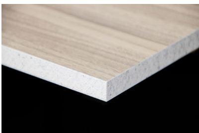
Bildtext 1: „A2-Solution“ ist ein nicht brennbares Verbundelement aus einer Gipsfaserplatte und einer in Anlehnung an die DIN EN 438-1 und EN 438-9 klassifizierten dekorativen 0,7 mm starken Laminatbeschichtung. Foto: Homapal
