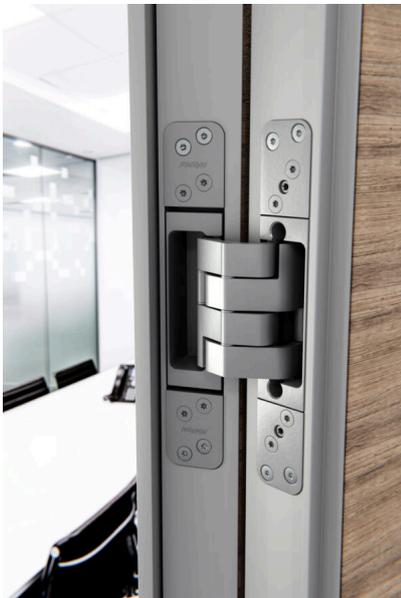
*Bildtext: Das verdeckt liegende Band „Pivota DX 110 3-D“ überwindet Aufdopplungen sowohl auf Flügel- als auch auf Zargenseite bis zu 10 mm. Die Tragfähigkeit beträgt 100 Kilogramm pro Paar. Fotos: Basys*
